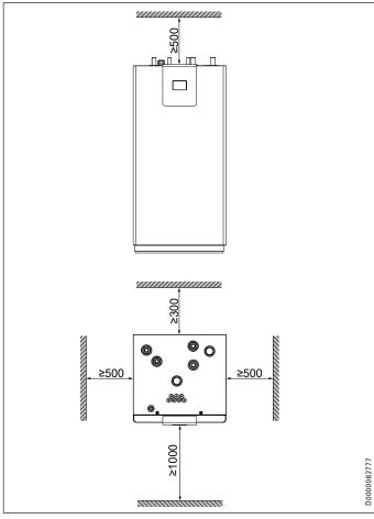
► Halten Sie die Mindestabstände ein, um einen störungsfreien Betrieb des Gerätes zu gewährleisten und Wartungsarbeiten am Gerät zu ermöglichen.
