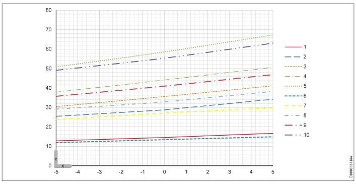
X Temperatur der Wärmequellenanlage [°C] Y Heizleistung [kW] Vorlauftemperatur 35 °C [U/min] 1 1500 3 3600 5 6000 2 3000 4 4500 Vorlauftemperatur 55 °C [U/min] 6 1500 8 3600 10 6000 7 3000 9 4500
