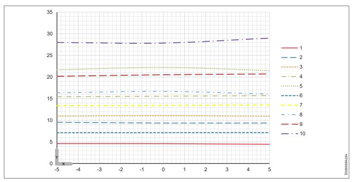
X Temperatur der Wärmequellenanlage [°C] elektrische Aufnahmeleistung [kW]
