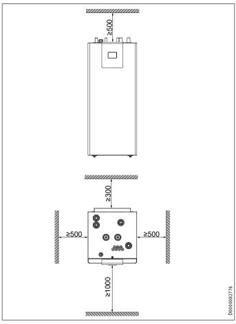
► Halten Sie die Mindestabstände ein, um einen störungsfreien Betrieb des Gerätes zu gewährleisten und Wartungsarbeiten am Gerät zu ermöglichen.
