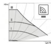
Recommandation pour les installations dont la résistance est invariable et qui nécessitent un débit volumique constant.
