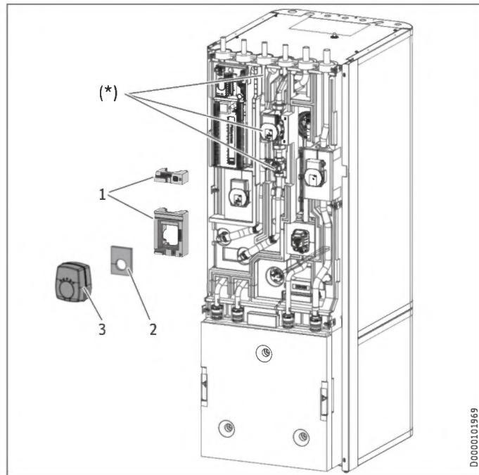
(\*)Module tuyauterie installé
