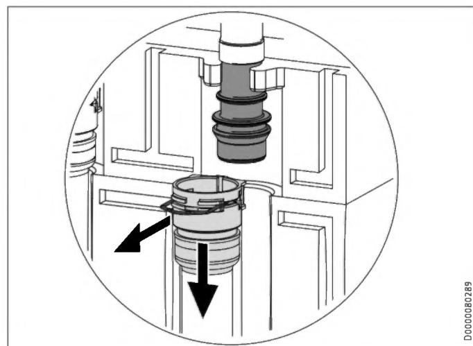
► Allentare i connettori sfilabili dei 4 allacciamenti idraulici. A tale scopo sfilare i morsetti elastici con un cacciavite fino all'arresto.
