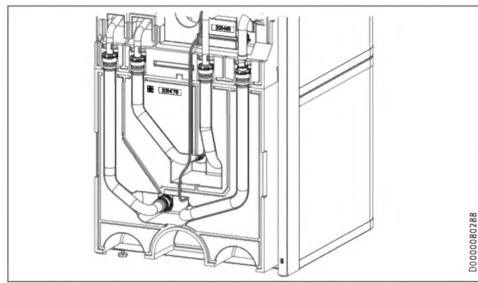
► Staccare il cavo del sensore dalla scanalatura di guida sull'elemento isolante.
