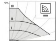
Empfehlung bei Anlagen mit unveränderlichem Anlagenwiderstand, die einen konstanten Volumenstrom erfordern.
