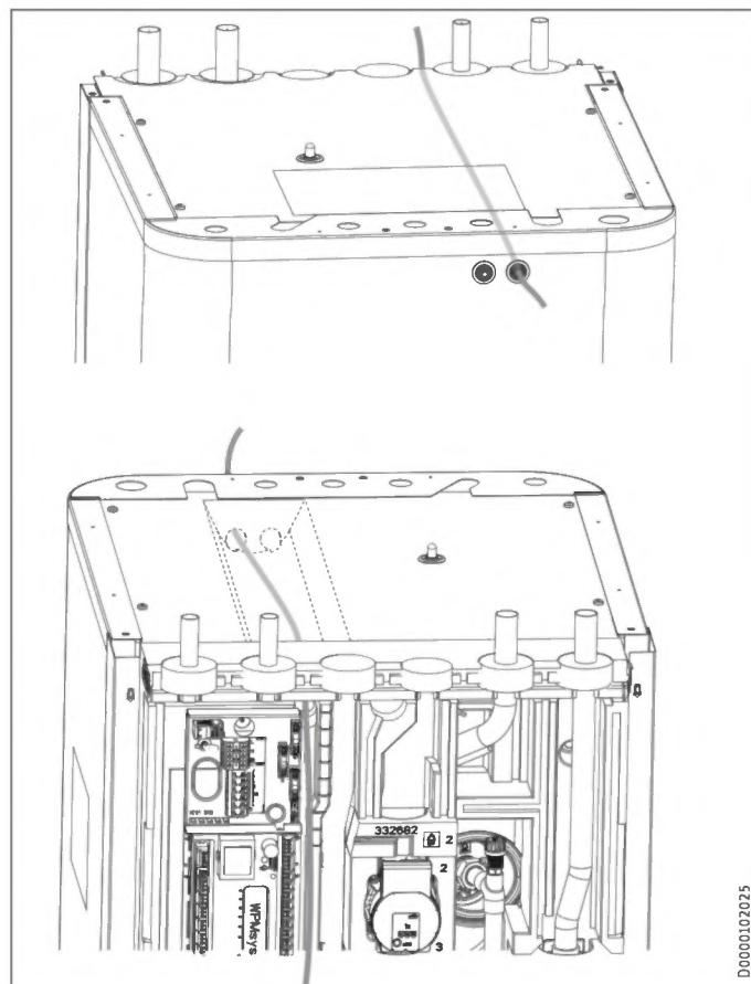
► Steek alle netaansluit- en sensorkabels door de kabeldoorvoer in het toestel.
