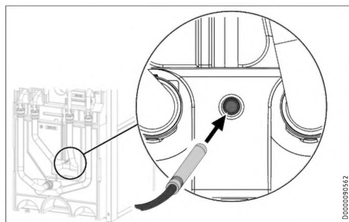
► Stecken Sie den Temperaturfühler in die Fühlerhülse „Fühler WP Kühlen optional“.
