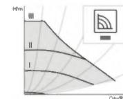
De regeling houdt de ingestelde opvoerhoogte constant, onafhankelijk van het gevraagde debiet.
