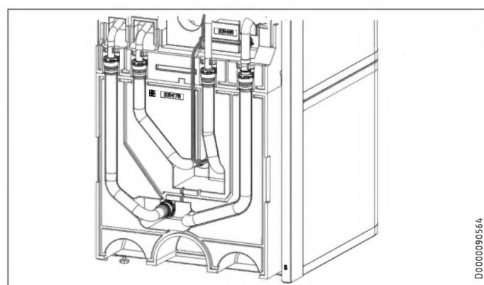
► Verlegen Sie das Fühlerkabel in der dafür vorgesehenen Führungsnuß im Dämmelement.
