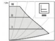
Die Pumpe reduziert die Förderhöhe bei sinkendem Volumenstrom im Rohrleitungsnetz auf die Hälfte. Einsparung von elektrischer Energie durch Anpassung der Förderhöhe an den Volumenstrombedarf und geringere Fließgeschwindigkeiten.
